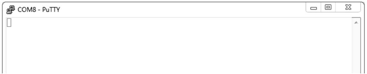
При подключении аппарата и запуске передачи в открывшемся окне будут выводиться принимаемые данные. Они автоматически сохраняются в файл, указанный при настройке соединения. Для завершения приёма данных закрыть программу PuTTY кнопкой [x] в верхнем правом углу окна.
